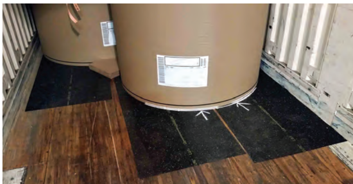
شکل ۱۴- نمونه ای از لایه های افزاینده اصطکاک
