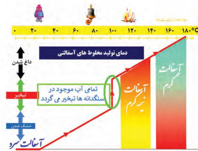
شکل ۲۵- دسته بندی آسفالت بر اساس دمای تولید آسفالت
