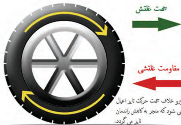
شکل ۱- جهت غلتش تأیر و مقاومت غلتشی
