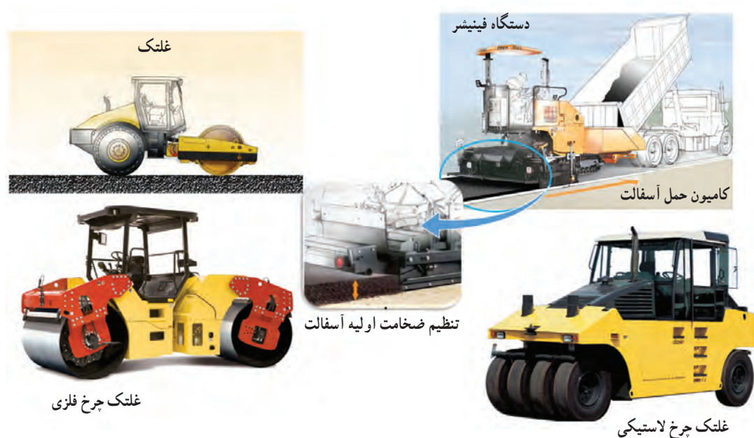
شکل ۳۰- تجهیزات پخش و تراکم آسفالت
