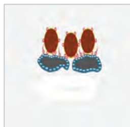
جذب ذرات قیر به سطح سنگ دانه ها
