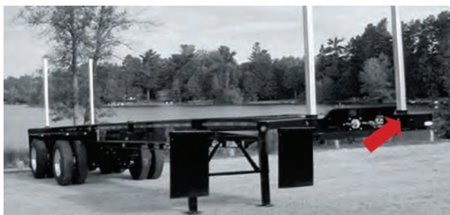
شکل ۲۰- قرار گرفتن ستون‌ها در جاستون‌ها روی کفی
