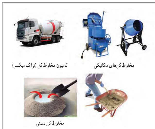
شکل ۱۱- انواع روش های اختلاط بتن
