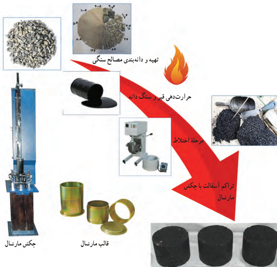
شکل ۲۷- فرایند تولید آسفالت در آزمایشگاه
